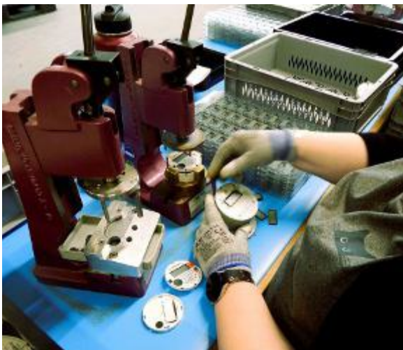
Aus Alt wird Neu: Wasserzähler werden geprüft und zurück in den Produktionskreislauf gebracht.
